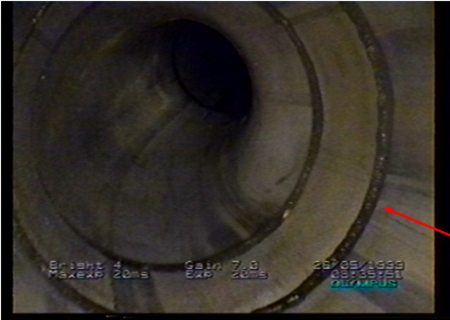
Figur 11. Gode svejsninger med god baggasdækning uden farver og med en pæn ensartet svejserod.
