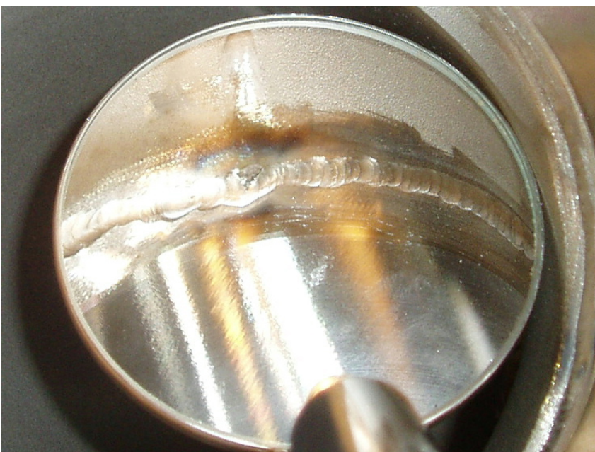
Figur 10. Efter fuldsvejsning ses ophæftningspunktet med koksdannelse i svejseroden og farveaftegninger. (Et spejl er sat ind i røret – det er spejlbilledet, man ser).
