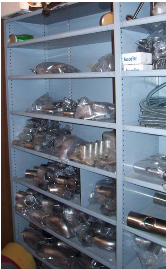
Figur 5. Eksempel på korrekt opbevaring af fittings.
