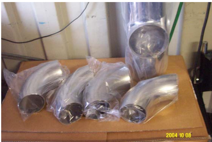
Figur 4. Eksempler på korrekt indpakkede fittings.
