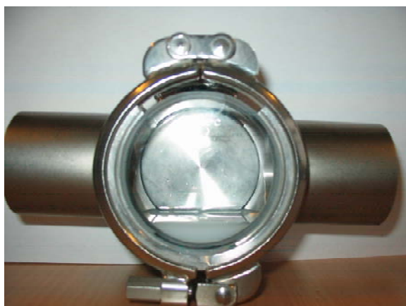
Figur 1. Illustrerer, hvordan et kugleformet ventilhus eller instrumenthus kan give anledning til manglende dræning ved forkert indbygning. Der vil konstant stå væske i bunden.
